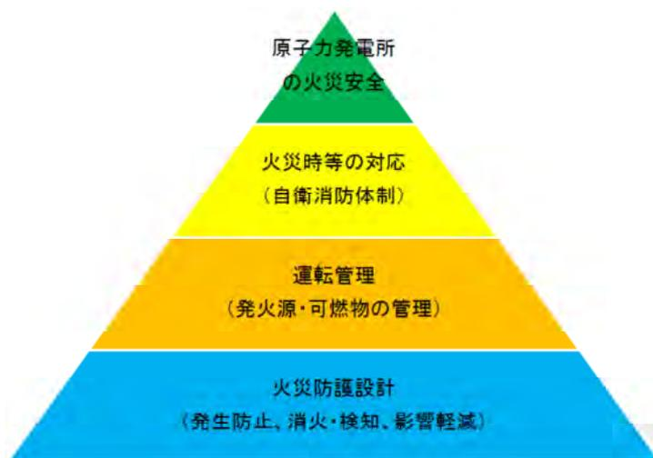
図12 原子力発電所の火災安全の考え方
