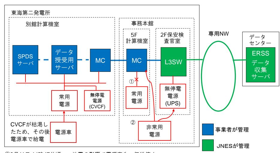
①3月11日 14時47分頃 ②3月11日 18時頃 地震の影響で電源喪失・伝送停止 急遽、非常用電源から延長コードで接続・復旧
