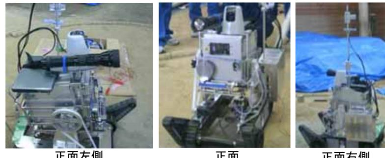
ロボット(PackBot:ガンマカメラ搭載)
