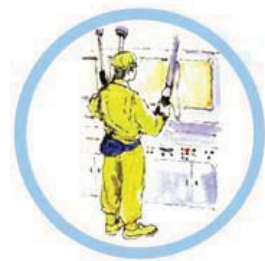
高い遮へい機能を有する部屋 (ホットセル)と遠隔操作 (マニピュレータ)の例
