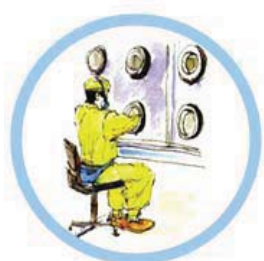
グローブボックスの例 試験雰囲気制御、汚染拡大防止
