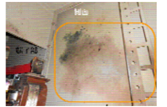
5 Aユニット側面のアーク痕状況
