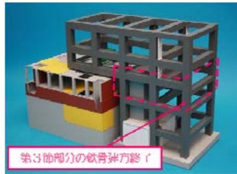
鉄骨建方完了イメージ
