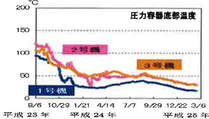
<1～3号機圧力容器底部温度、格納容器気相温度の確認>
