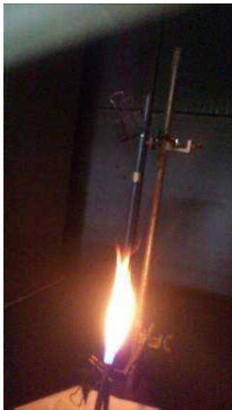
自己消化性の実証試験の例（UL垂直燃焼試験）
