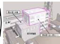
燃料取り出し用カバーの設置
