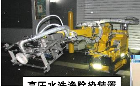
高圧水洗浄除染装置
