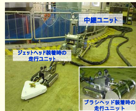
<遠隔操作除染ロボット(名称：ラクーン)>
