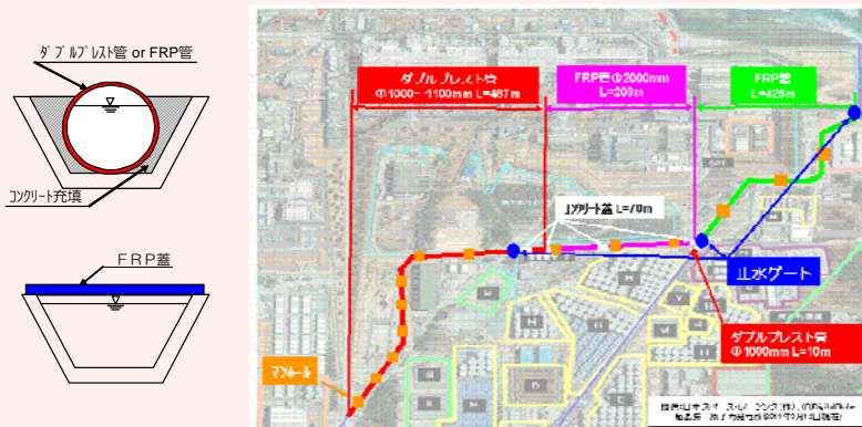
暗渠化実施状況
