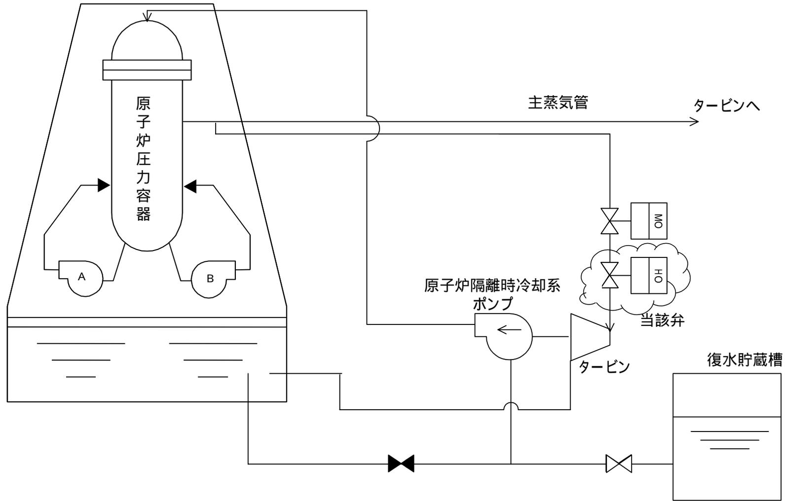
柏崎刈羽原子力発電所1号機 原子炉隔離時冷却系概略系統図
