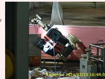
遠隔操作ロボット転倒状況
