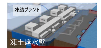
(延長: 約1,500m、凍土量: 約7万m 3 )
