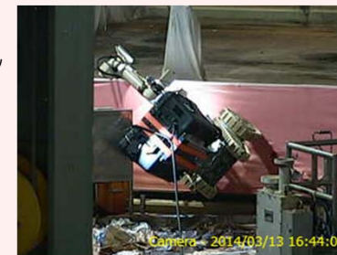
遠隔操作ロボット転倒状況
