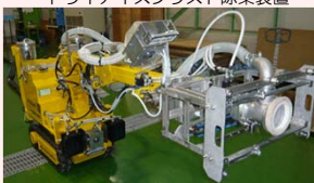
高圧水除染装置
