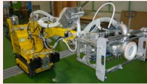
高圧水除染装置
