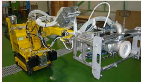
高圧水除染装置
