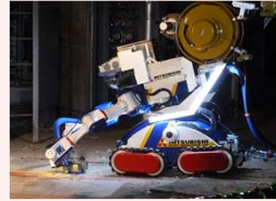
吸引・プラスト除染装置
