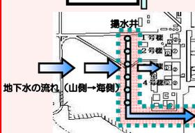
山側から流れてきた地下水を建屋の上流で揚水し、建屋内への地下水流入量を抑制する取組 (地下水バイパス) を実施。くみ上げた地下水は一時的にタンクに貯留し、東京電力及び第三者機関により、運用目標未達であることを都度確認し、排水。揚水井、タンクの水質について、定期的にモニタリングを行い、適切に運用。建屋と同じ高さで設置した観測孔において地下水位の低下傾向を確認。建屋への地下水流入をこれまでのデータから評価し、減少傾向を確認。
