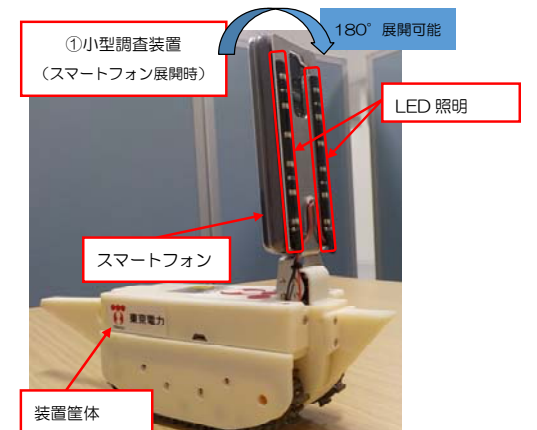
図6：3号機PCV機器ハッチ調査用小型調査装置
