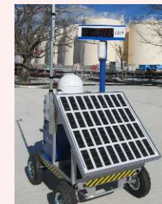
線量率モニタの設置状況
