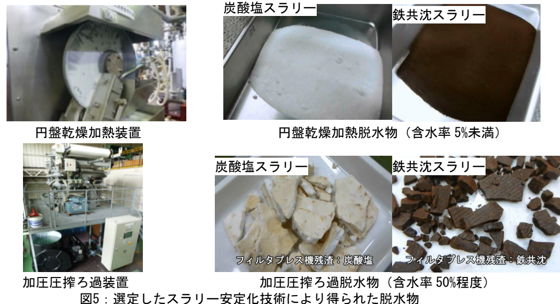
図5：選定したスラリー安定化技術により得られた脱水物
