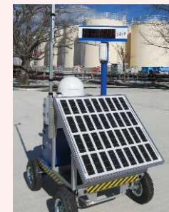
線量率モニタの設置状況
