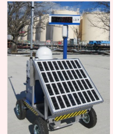
線量率モニタの設置状況
