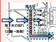
山側から流れてきた地下水を建屋の上流で揚水し、建屋内への地下水流入量を抑制する取組(地下水バイパス)を実施。
