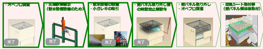
建屋カバー解体の流れ(至近の工程)
