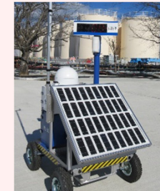
線量率モニタの設置状況
