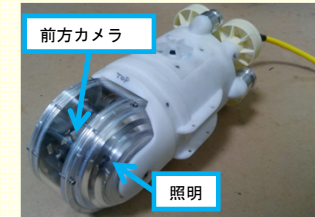
※：原子炉圧力容器を支える基礎 <水中遊泳式遠隔調査装置>
