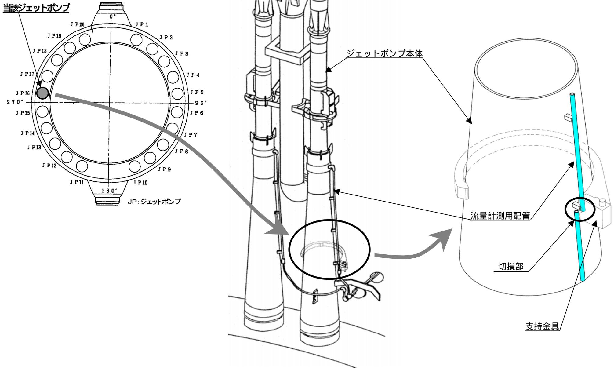
切損したジェットポンプ流量計測用配管状況図
