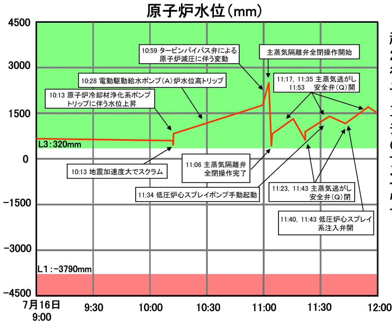
起動中(未臨界)の2号機においては、復水ポンプにより原子炉水位を維持。主蒸気逃がし安全弁による減圧操作の過程で、復水ポンプ、制御棒駆動水ポンプに加えて低圧炉心スプレイ系も用いて冷却水を補給。
