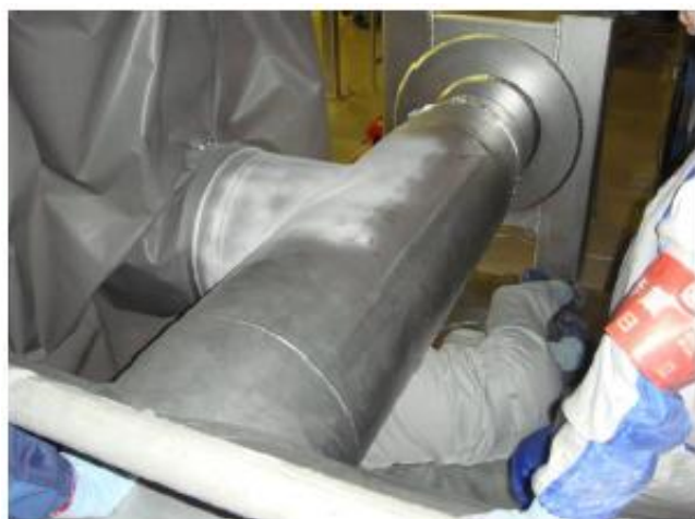
浸透探傷試験の実施状況
