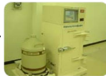
ゲルマニウム半導体検出装置にて8万秒計測します
