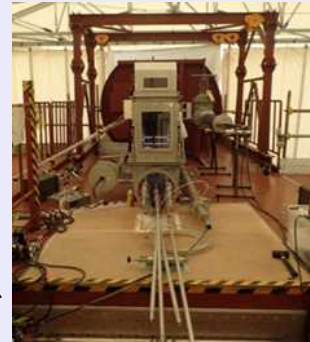
＜水中ROVを投入・回収する装置の設置イメージ（モックアップ時）＞
