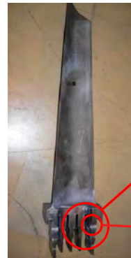
第14~16段 動翼の構造 (付根部:フォーク型)
