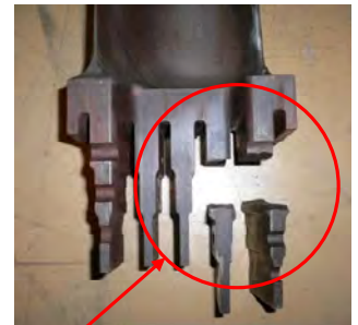
第14段動翼の損傷状況 (折損)
