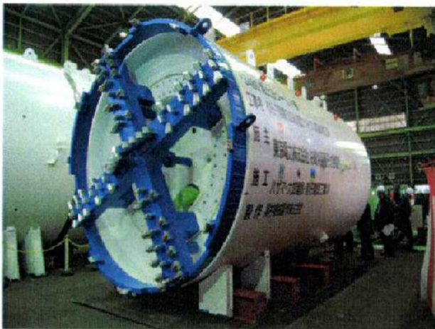
新設洞道掘削時のシールドおよび施工写真
