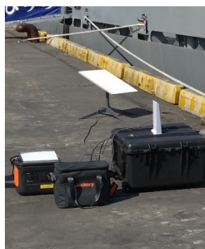
衛星回線アンテナ
