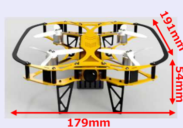
＜1号機の調査で使用した小型ドローン＞
